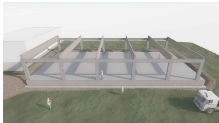
8 TRAVI PRINCIPALI DI COPERTURA
